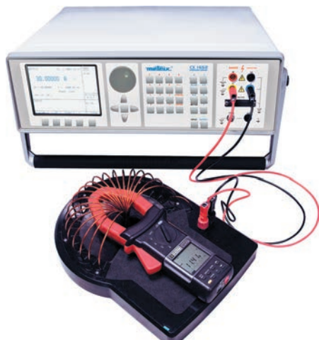
CX 1652, pour vérifier simplement une pince ampèremétrique.
